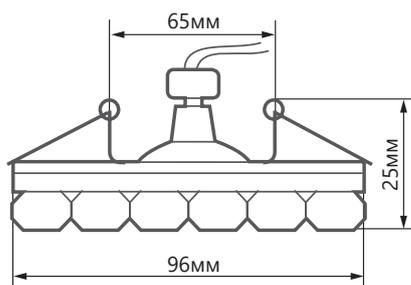
Расширение популярной серии встраиваемых светильников с боковой подсветкой. Элегантный встраиваемый светильник **CD940** украсит интерьер и предоставит возможность дополнительной подсветки помещения. Светильник подсвечивается встроенными в корпус светодиодами, что позволяет увидеть фактуру и красоту светильника во включенном состоянии.
